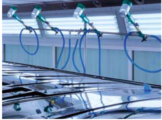
Větší plošná účinnost díky nasazení až 4 sušících ofukovacích pistolí na stativu
