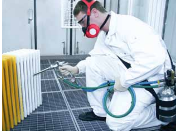
SATA mini set 2 k mobilnímu nasazení včetně opasku a popruhu na ramena zaručující optimální svobodu pohybu pro uživatele.
