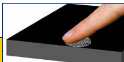
Rez způsobená nečistotou: rez může vyvolat i otisk prstu na obnaženém plechu.
