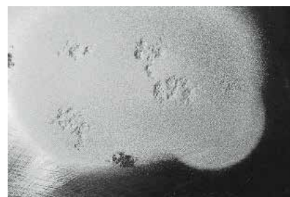
Důlkovou korozi je třeba opískovat před dalším zpracováním.
