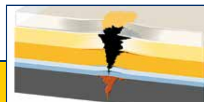
Důsledek: pod vrstvou laku začne vznikat rez.
