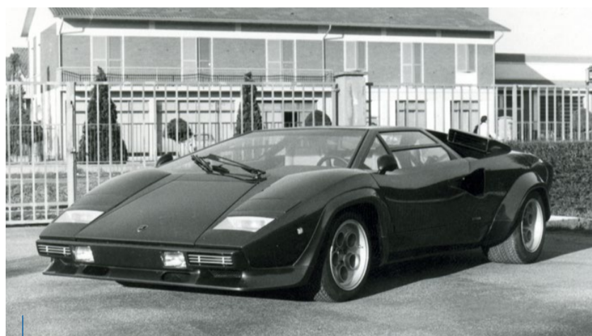
Lamborghini Countach LP 400 S se odlišoval širokými koly s pneumatikami Pirelli a laminovanými lemy blatníků
