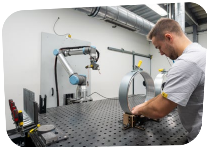
1 / Svařovaný díl je umístěn a pečlivě usazen do lůžka.
