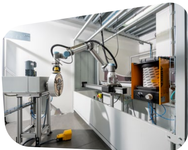
7 / Součástí pracoviště je i Mirka AutoChanger System, který slouží pro automatizovanou výměnu brusiva.
