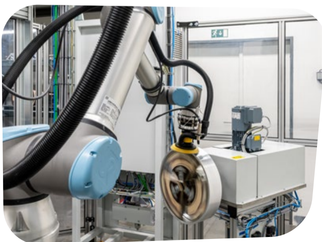
8 / Brusná operace probíhá ve třech krocích – zčištění opačné strany svaru, broušení vnější plochy dílu a zčištění vnější hrany výrobku.
