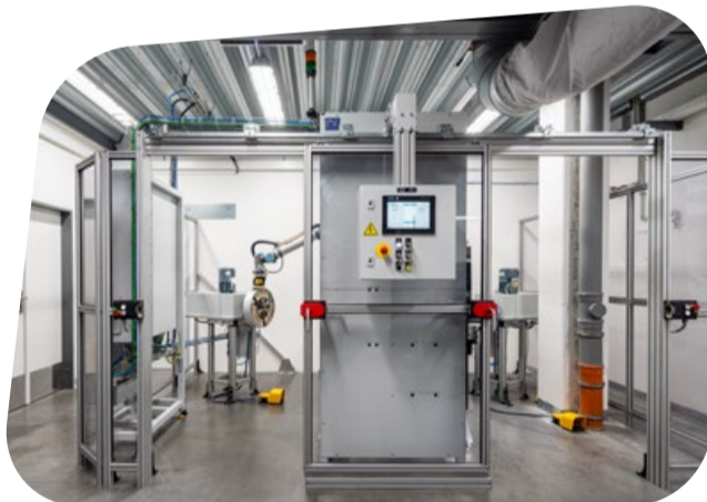
5 / Brusná pracoviště vybavená rotačními fixátory broušených dílů.
