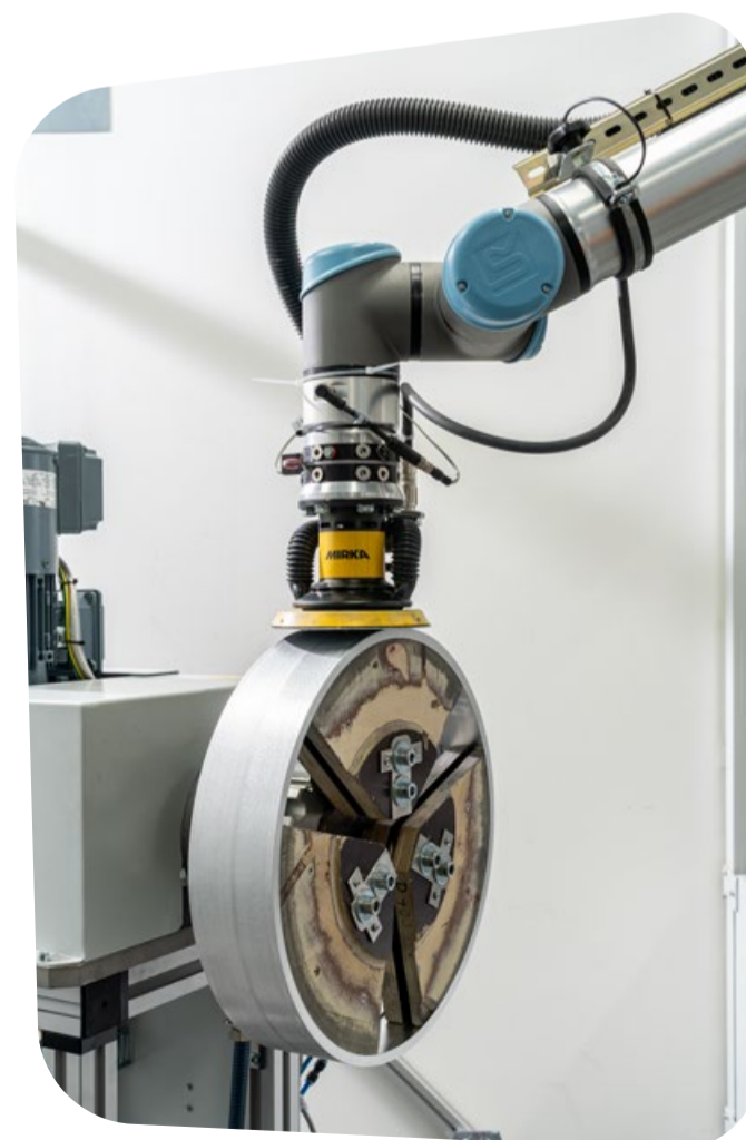
6 / Kolaborativní robotické rameno UR10 je osazeno robotickou brusnou hlavou Mirka AIROS.
