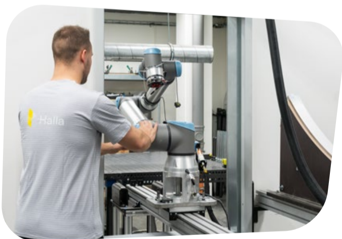
4 / Snadný přesun kolaborativního robotického ramene po kolejnici mezi oběma pracovišti.
