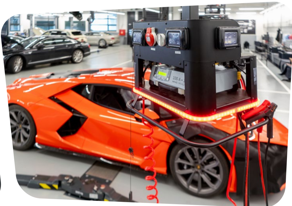
5 / Energy hnízda PowerLab integrují příklady energií, stlačeného vzduchu, datového připojení a nabíječku akumulátorů.
