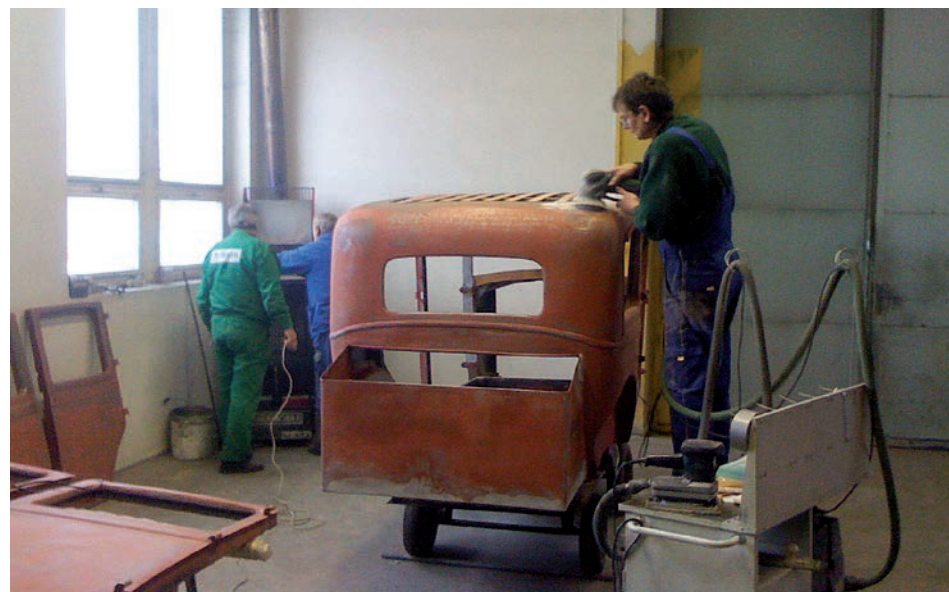
Důkladné odbroušení původního laku a nekonečné tmelení bylo nezbytností.
