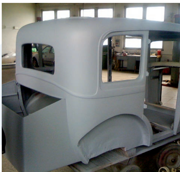
Už se to začíná rýsovat. Karoserie v plniči.
