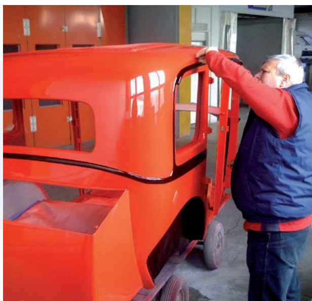
Odstraňování přesně maskovací pásky a kontrola laku.
