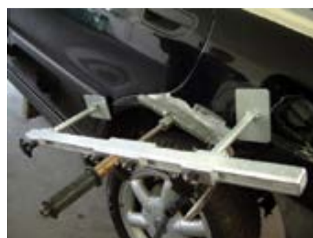
Oprava vytažením pomocí bitů, vyťahovací tyče a základny
